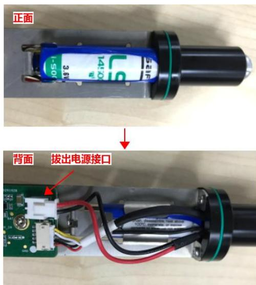
图 2 电池安装示意
