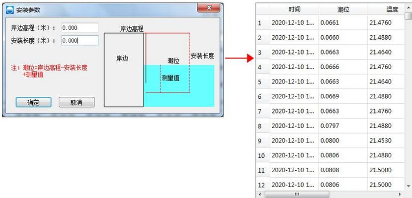
图 19 没填安装参数的潮位
